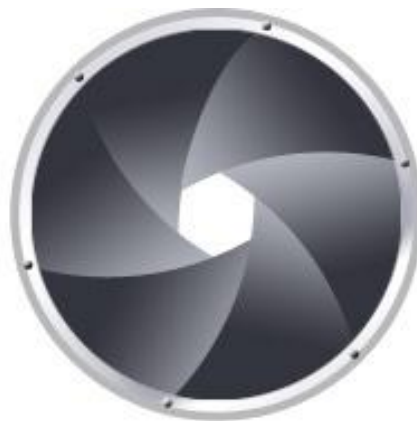
MALI OTVOR BLENDE (ulazi malo svetlosti) f/22
