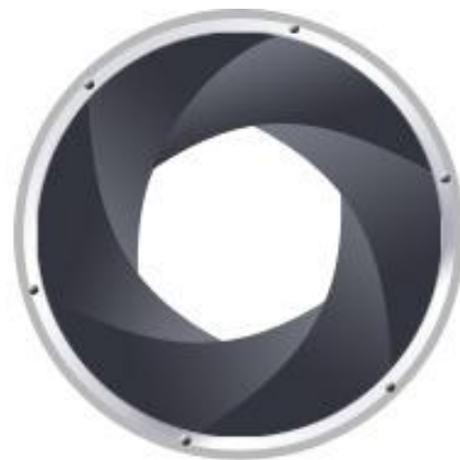
SREDNJI OTVOR BLENDE (srednja količina svetlosti) f/8
